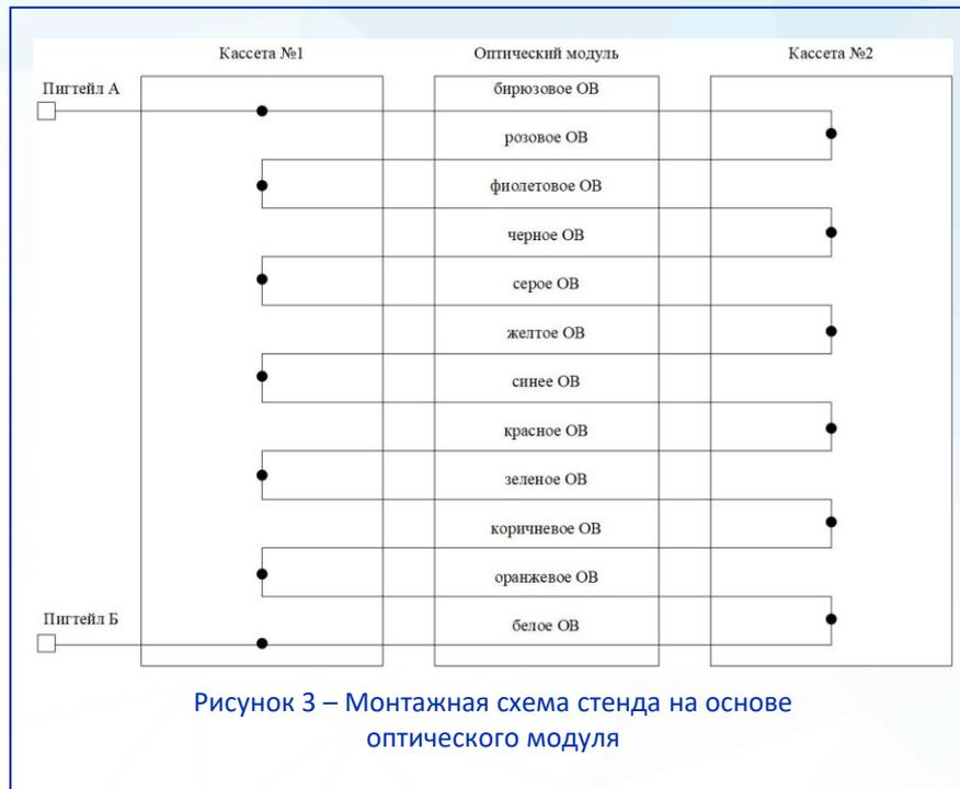
Лабораторный стенд на основе оптического кабеля представляет собой оптический кабель марки ОКЛ-01-6-16-10/125-0,36/0,22-3,5/18-1,0 длиной порядка 900 м на кабельном барабане. В кабеле располагаются 4 модуля по 4 волокна в каждом модуле.
