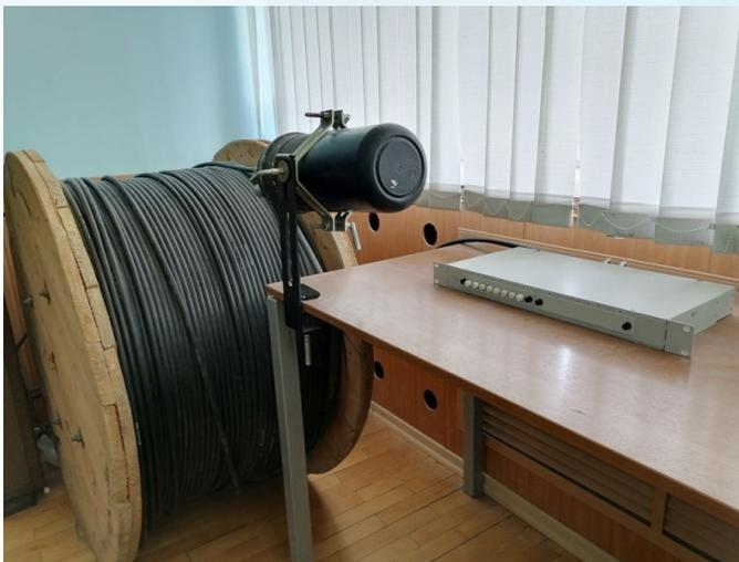
Рисунок 5 – Лабораторный стенд на основе оптического кабеля
