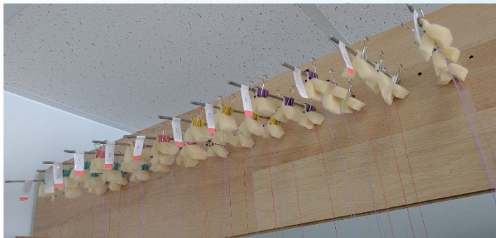
Рис. 1 Стенд для искусственного состаривания ОВ
