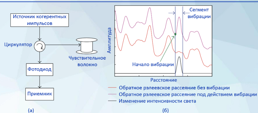
Рис.1 (а) Схема простой конфигурации ф-OTDR и (б) изменение интенсивности света в месте действия вибрации
